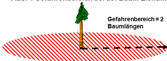
Abb. 4 Gefahrenbereich bei der Baum-Zielfällung
